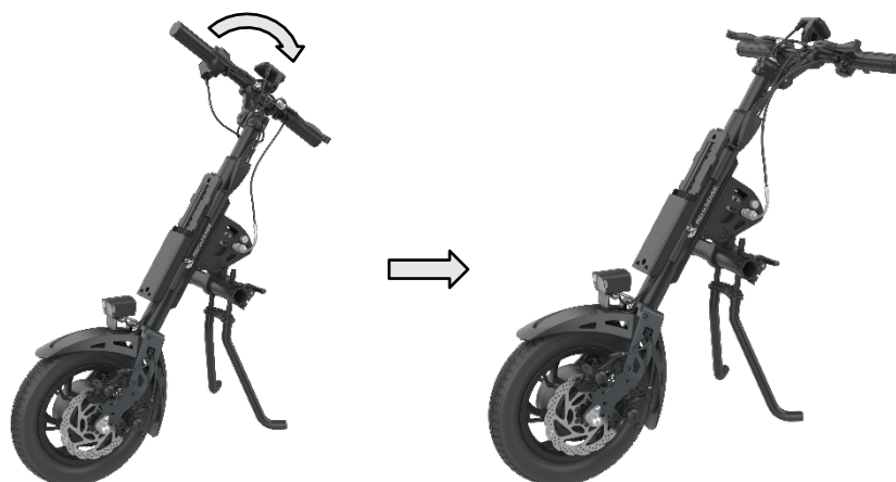
Figur 14. Montering av styrstägar i arbetsposition
