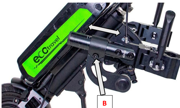
Figur 22. Visa djupjusteringen av clamp mekanism i förhållande till enheten
