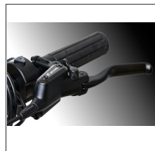
KRAFTIGA BROMSAR Dubbla hydrauliska bromsar med parkeringsbroms.
